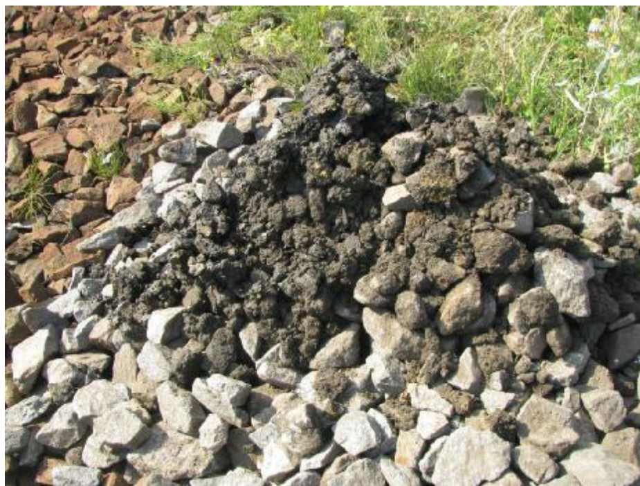
Detail zahliněné a zvodněné štěrkodrtě konstrukční vrstvy
