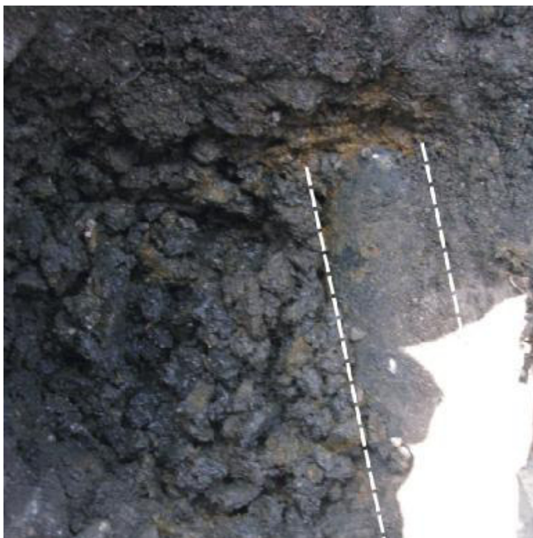
Detail ocelové chráničky inženýrských sítí ověřené v průběhu terénních prací
